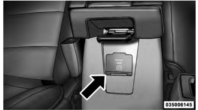
115 Volt Power Outlet
