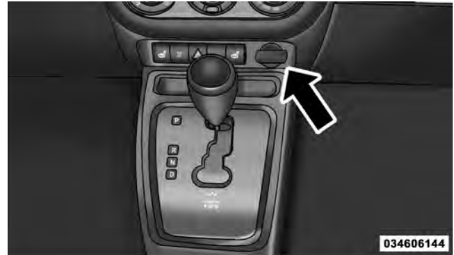
12 Volt Power Outlet
