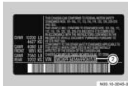
Exemple d'étiquette d'homologation de sécurité du véhicule incomplète (véhicules américains)
