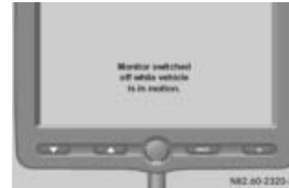
Si la vitesse chute au-dessous de 8 km/h (5 mi/h), le moniteur se rallume.
