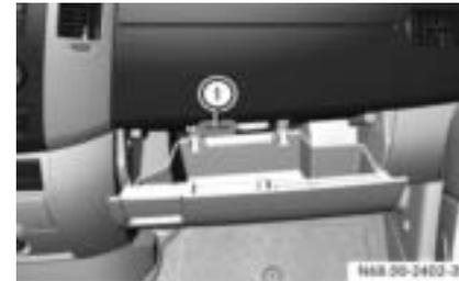
① Ouverture / fermeture de l'arrivée d'air
