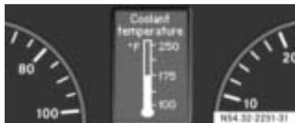
La température affichée peut atteindre 120 °C (250 °F) lorsque le véhicule roule dans des conditions normales et que le liquide de refroidissement du moteur renferme les concentrations adéquates
