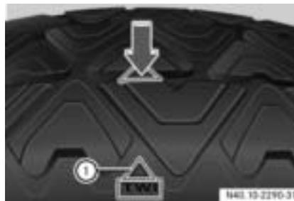
① Indicateur d'usure de la bande de roulement (TWI)
