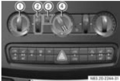
Bloc de commande de chauffage
