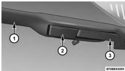
Balai d'essuie-glace avec patte de déverrouillage en position verrouillée
