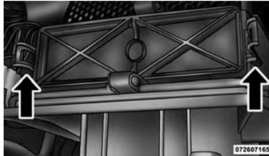
Remplacement du filtre à air du climatiseur
