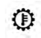
Pendant la conduite prolongée à haute vitesse ou la traction d'une remorque sur de longues pentes par temps chaud, l'huile à transmission automatique risque de devenir trop chaude. En pareil cas, le témoin de surchauffe de la transmission s'allume et le véhicule ralentit légèrement pour laisser la transmission automatique refroidir suffisamment pour permettre le rétablissement de la vitesse
