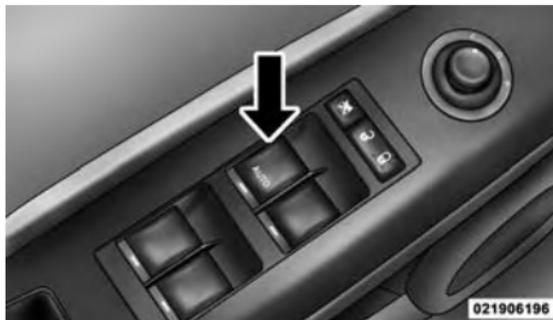
Emplacement des commutateurs des glaces à commande électrique
