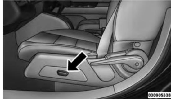
Commutateur de siège à commande électrique
