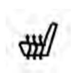
Appuyez une fois sur le commutateur pour sélectionner le chauffage de niveau HI (ÉLEVÉ). Appuyez une deuxième fois sur le commutateur pour sélectionner le chauffage de niveau LO (BAS). Appuyez une troisième fois sur le commutateur pour mettre les éléments de chauffage HORS FONCTION.
