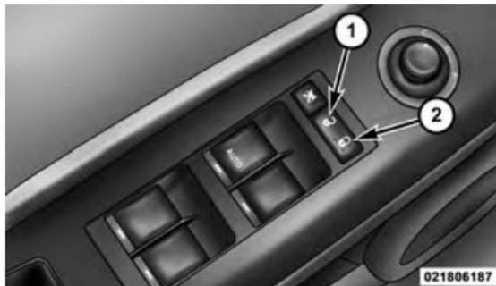
**commutateur de verrouillage électrique des portières côté conducteur**
