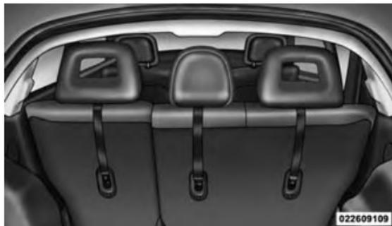
Ancrages d'attache de siège arrière
