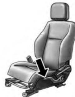
Levier de réglage de la hauteur du siège
