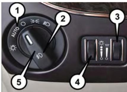
**Commutateur des phares et d'éclairage à halogène**
