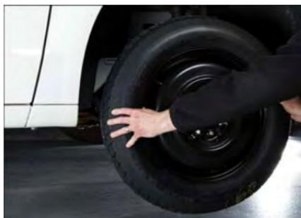
Installation de la roue de secours compacte
