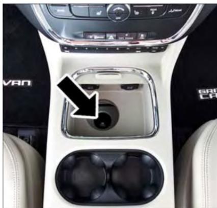
Emplacement l'écrou de commande du treuil
