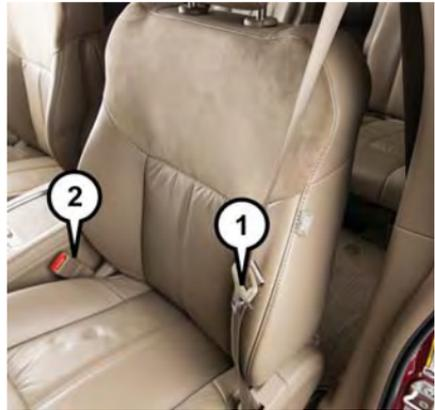
**Verrouillage et positionnement de la ceinture de sécurité**
