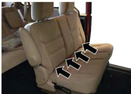
**Ancrages inférieurs du système LATCH de banquette de 2 rangée**
