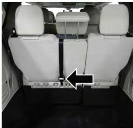
**Ancrages de courroie d'attache (ancrage de troisième rangée 60/40 illustré)**
