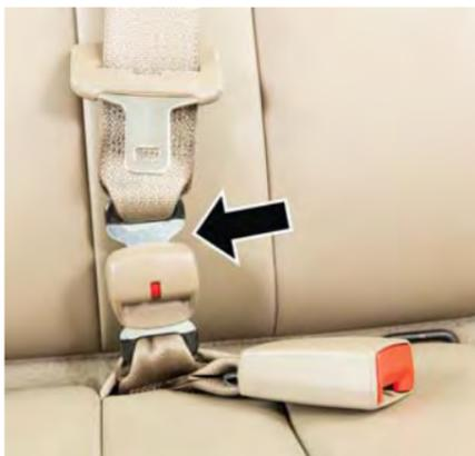
**Raccordement de la mini-langnette à la boucle assortie**
