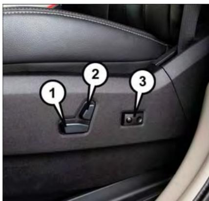
**Commutateur de siège à commande électrique du conducteur**
