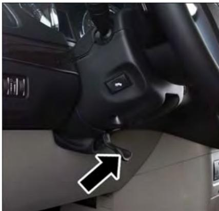
Levier d'inclinaison et de réglage télescopique
