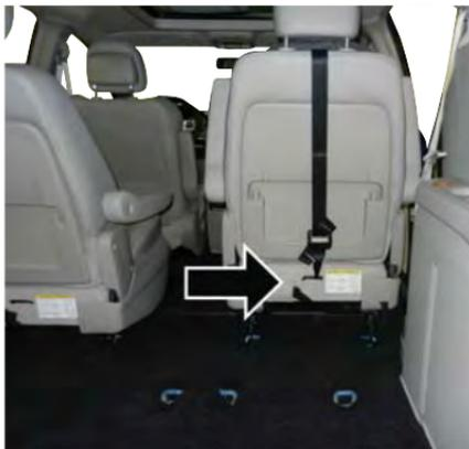
**Montage de la courroie d'attache du siège arrière (ancrage du siège capitaine de la deuxième rangée illustré)**
