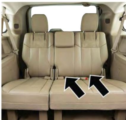
**Ancrages inférieurs du système LATCH des sièges 60/40 de 3 rangée**
