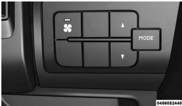
Commutateur de réglage du système de chauffage-climatisation arrière supplémentaire
