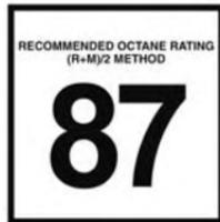
Ce moteur est conçu en conformité avec tous les règlements antipollution et offrent une économie de carburant et un rendement excellents avec de l'essence « ordinaire » sans plomb de qualité supérieure d'un indice d'octane de 87 tel qu'indiqué par la méthode (R+M)/2.
