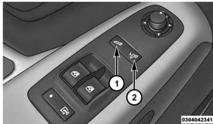
Commutateur des rétroviseurs rabattables à commande électrique
