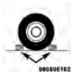
6. Calez l'avant et l'arrière de la roue diagonalement opposée à la position de levage. Par exemple, si vous changez le pneu avant droit, bloquez la roue arrière gauche.
