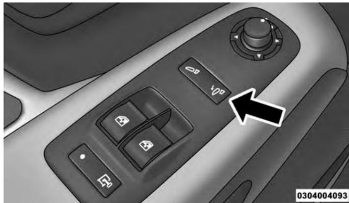
Emplacement du commutateur des rétroviseurs rabattables à commande électrique
