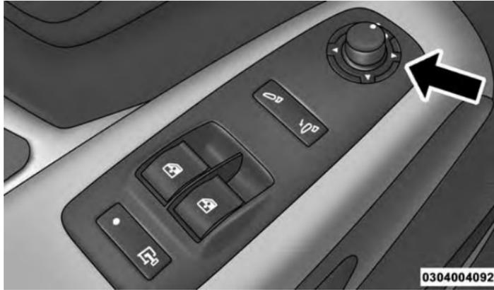
Commandes des rétroviseurs électriques
