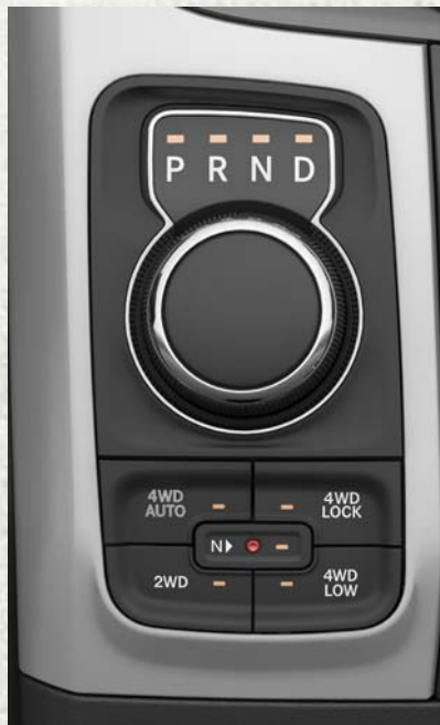
Boîte de transfert à cinq positions/sur demande – Transmission à huit rapports uniquement
