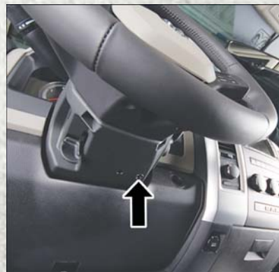
Port d'accès de neutralisation manuelle du blocage de changement de vitesse
