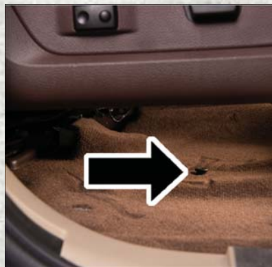
Emplacement des fixations du plancher
