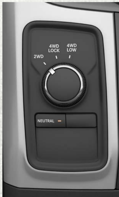
Boîte de transfert à quatre positions/à prise temporaire
