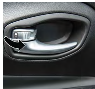
Manual Door Lock
