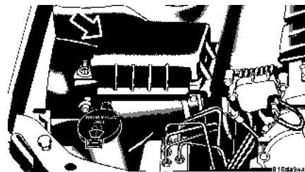
Centrale de servitudes avant
