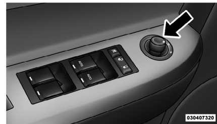
Commutateur de réglage de rétroviseur à commande électrique
