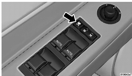
Interrupteur de verrouillage de glace à commande électrique
