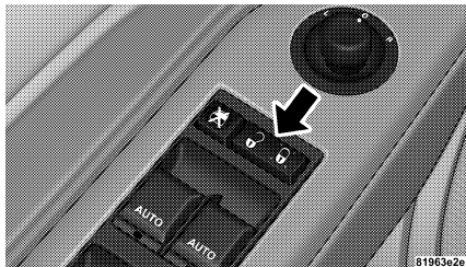
Commutateur de verrouillage électrique des portes
