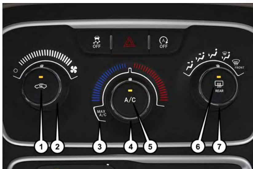
Système de chauffage-climatisation manuel
