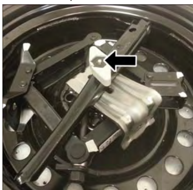
Dispositif de retenue
