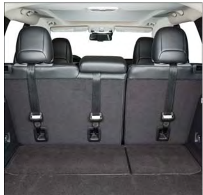
Emplacements des ancrages d'attache
