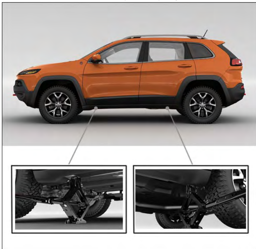
Emplacements de levage
