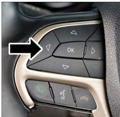
Commandes du centre d'information électronique (EVIC) ou de l'écran d'information du conducteur (DID)
