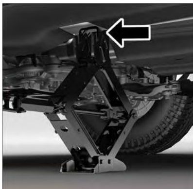
Emplacement de levage avant engagé
