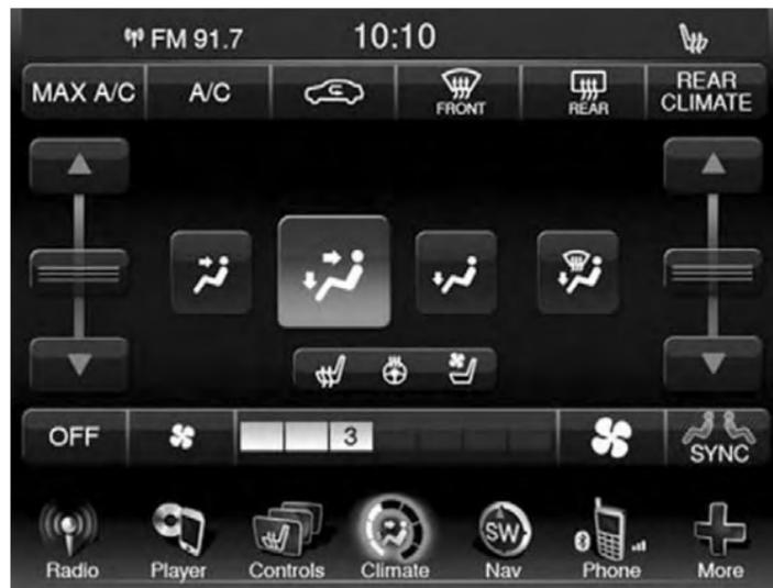
Système Uconnect 3/3 AVEC NAVIGATION avec affichage de 8,4 pouces et commandes de température à deux zones à réglage manuel
