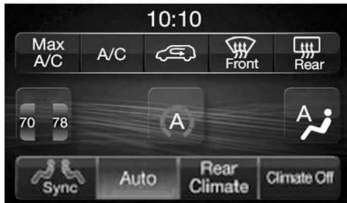
Commandes de température à trois zones à réglage automatique de la radio 4.3
