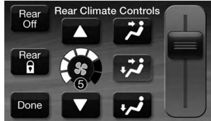
Commandes manuelles du système de chauffage-climatisation arrière de la radio 4.3
