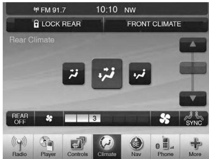
**Commandes manuelles du système de chauffage-climatisation arrière du système Uconnect 3/3 AVEC NAVIGATION**
