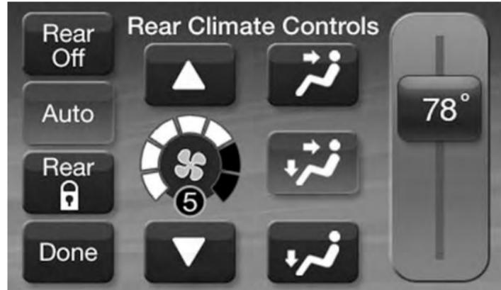
Boutons de l'écran tactile du système de chauffage-climatisation arrière automatique du système Uconnect 4.3
