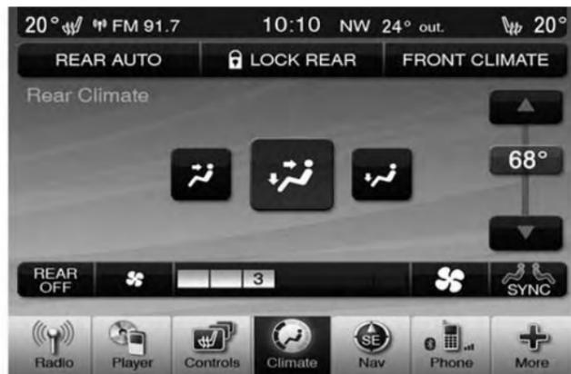
Boutons de l'écran tactile du système de chauffage-climatisation arrière automatique du système Uconnect 3/3
