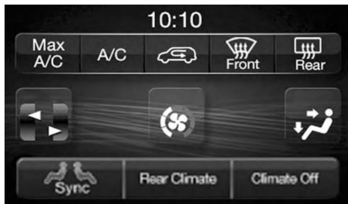
Commandes de température à trois zones à réglage manuel de la radio 4.3
