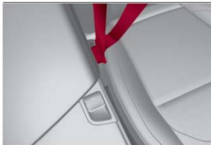
**Languette de ceinture de sécurité insérée dans la boucle de ceinture de sécurité**
