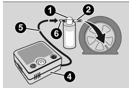
**Fixation du tube de remplissage sur un pneu dégonflé**
