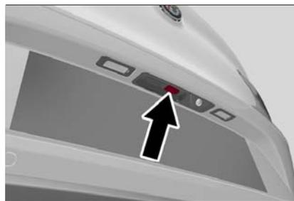
**Commutateur de déverrouillage extérieur du hayon**
