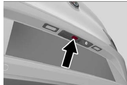
**Bouton du système de déverrouillage passif du hayon**
