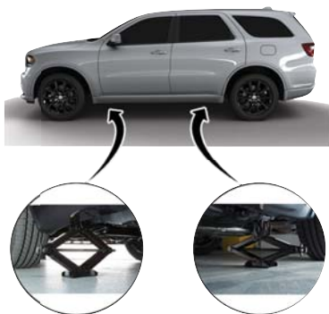
Emplacements de levage
