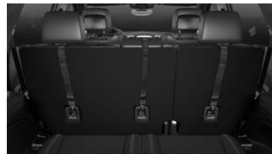
Fixation de la courroie d'attache supérieure pour véhicules à sept passagers (banquette de seconde rangée)
