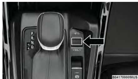
Commande rotative sur le tunnel central
