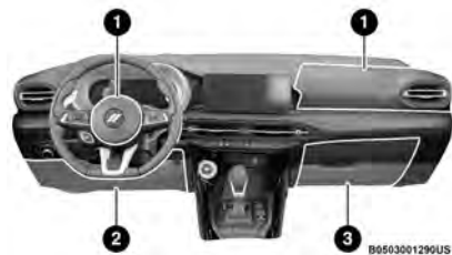
Emplacement des sacs gonflables avant et des protège-genoux
