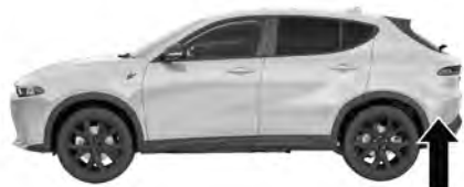
Emplacement du capteur de radar (côté conducteur illustré)
