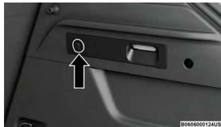
Emplacement du bouchon de déblocage
