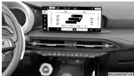
Commandes automatiques de chauffage-climatization du système Uconnect 5 ou 5 NAV avec écran de 10,25 po
