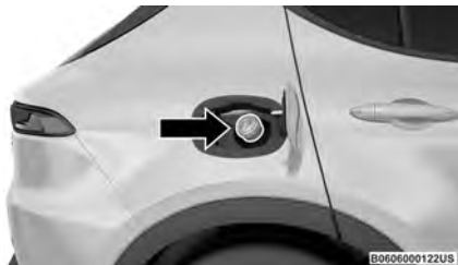
Tuyau du réservoir de carburant
