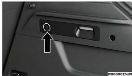
Emplacement du bouchon de déblocage
