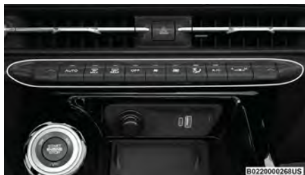
Commandes de chauffage-climatization dans le bloc central du tableau de bord
