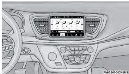
Commandes automatiques de température du système Uconnect 5/5 AVEC NAVIGATION avec écran de 10,1 po
