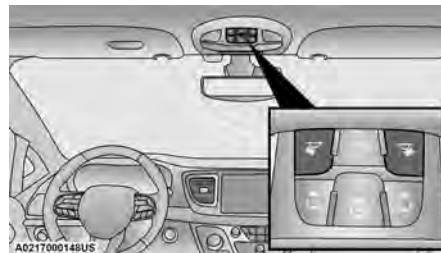
Commutateurs de l'éclairage d'accueil
