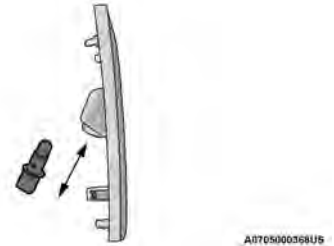
Dépose de l'ampoule du feu de gabarit avant
