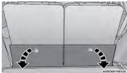
Accès à l'ancrage de courroie d'attache supérieure en tirant vers le bas sur le panneau de plancher recouvert de moquette (banquette de troisième rangée)
