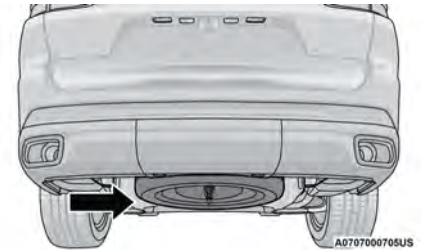
Roue de route installée dans l'emplacement de la roue de secours
